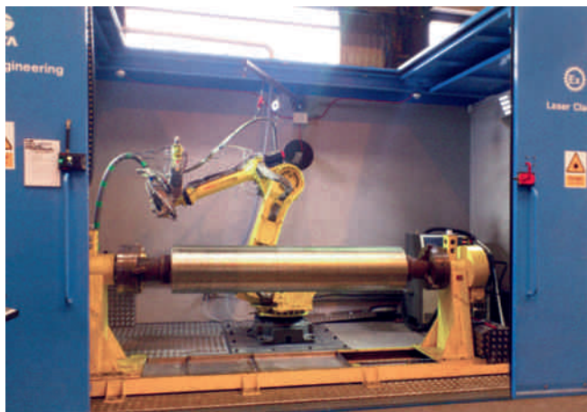
Laserbeschichtungsanlage in der Fertigung bei Tata Steel Strip Products UK.
