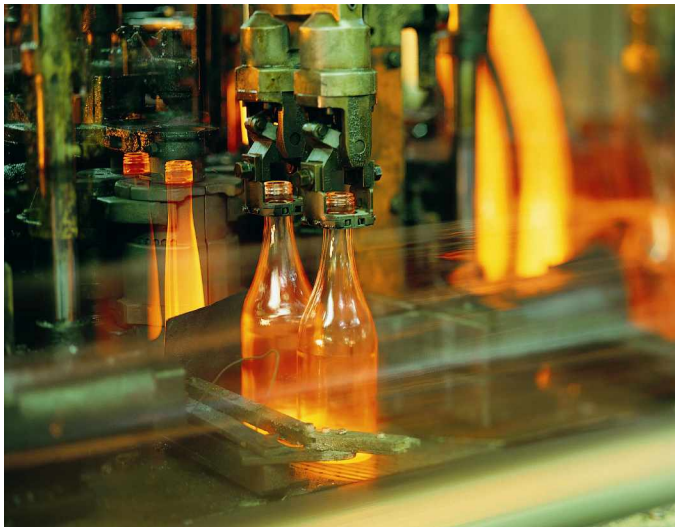
Schliereneffekte bei glühenden Glasflaschen haben keinen Einfluss auf die Messung
